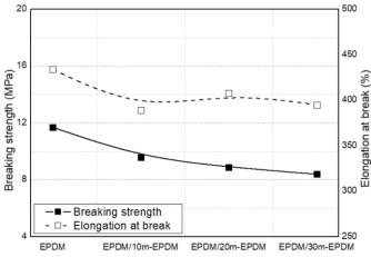
Figure 1. Breaking strength and elongation at break change (Kopma mukavemeti ve kopma uzaması değişimi)
