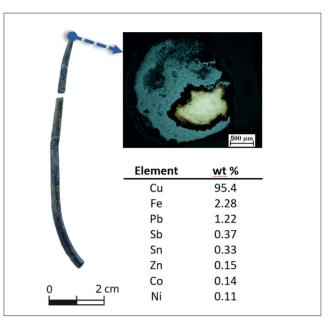
Figure 5. Sampled location on metal tool MH19-69, showing the metallography image of the cross-section captured with light microscope. Reported weight percentages of the elements were normalized to 100% / Metal aletin (MH19-69) numune alınan bölgesi ve bu numunenin kesitinden ışık mikroskobu ile elde edilen metalografi görüntüsü. Tabloda belirtilen ağırlık yüzdeleri %100'e normalize edilmiştir.
